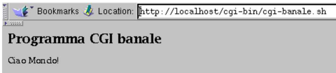
Figura 339.23. Risultato per l'utente della richiesta di accedere all'URI che punta allo script elementare ( 'cgi-banale.sh' ) che produce solo un output semplice senza interpretare alcun input.
