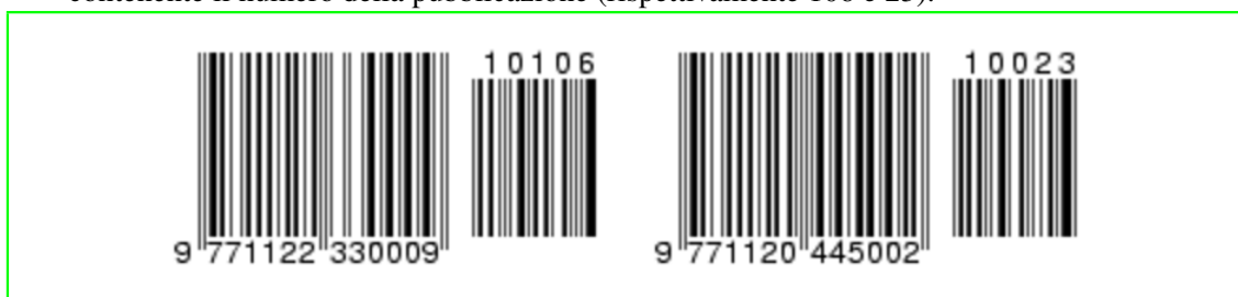
Figura 800.12. Esempio di due codici ISSN, riferiti a riviste, con un'estensione contenente il numero della pubblicazione (rispettivamente 106 e 23).
