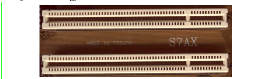
Figura 80.4. Un alloggiamento PCI a 32 bit su una scheda madre comune.
