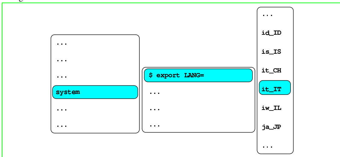
Figura 779.8. Selezione della configurazione locale durante il funzionamento in modalità grafica.
