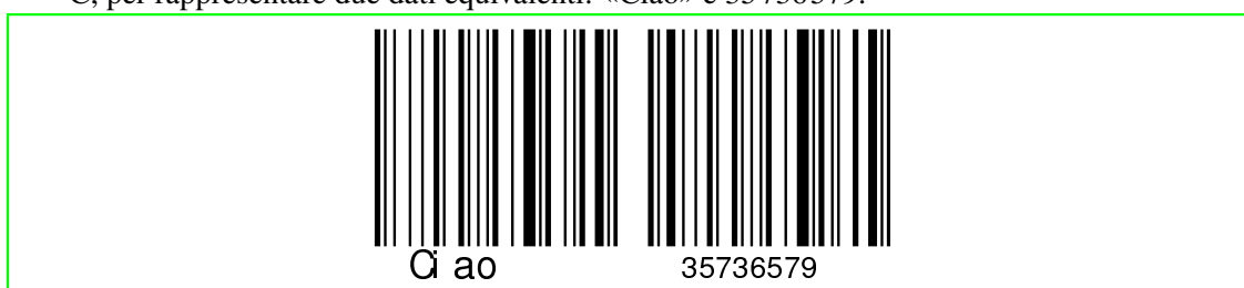
Figura 800.17. Esempio di due codici Code 128, realizzati usando l'insieme B e l'insieme C, per rappresentare due dati equivalenti: «Ciao» e 35736579.
