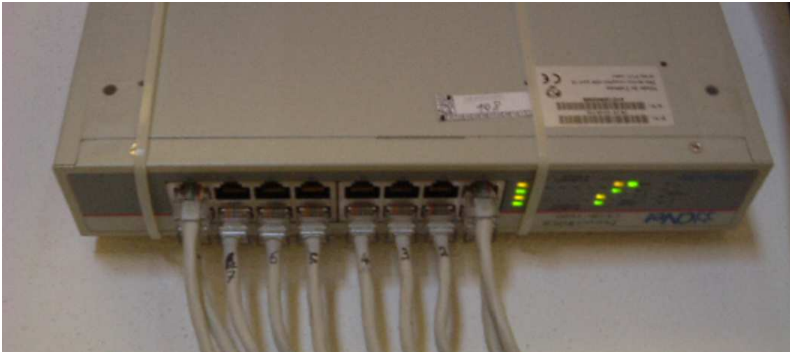
Figura 256.3. Componente per il raccordo dei collegamenti UTP, costituito generalmente da un commutatore di pacchetto ( switch ).
