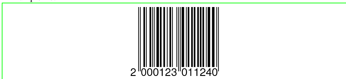
Figura 800.9. Esempio di un codice a barre con simbologia EAN-13, usato per annotare un prezzo.
