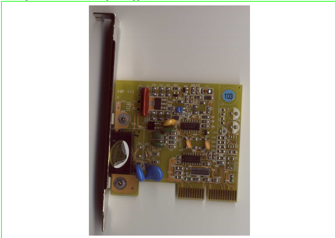
Figura 80.11. Un modem per alloggiamento AMR.
