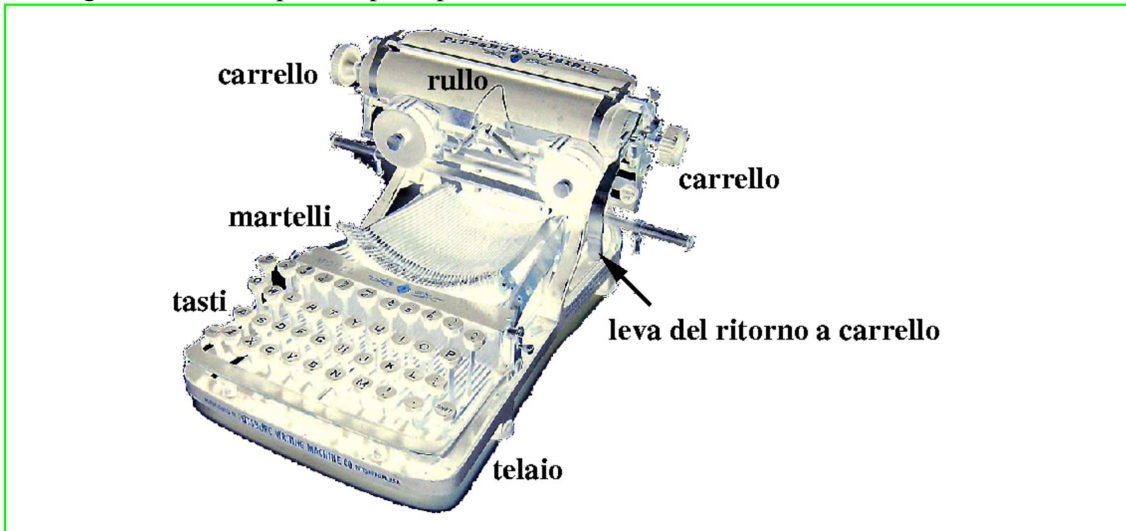
Figura 110.2. Componenti principali di una macchina da scrivere tradizionale.
