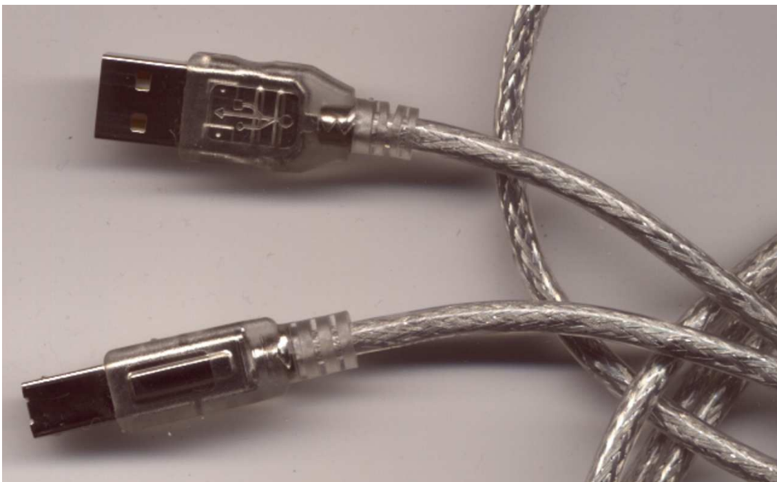
Figura 81.2. Un cavo USB, dove si possono notare i due connettori, «A» e «B», che hanno forme diverse.
