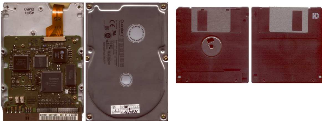
Figura 164.2. Disco fisso e disco rimovibile.
