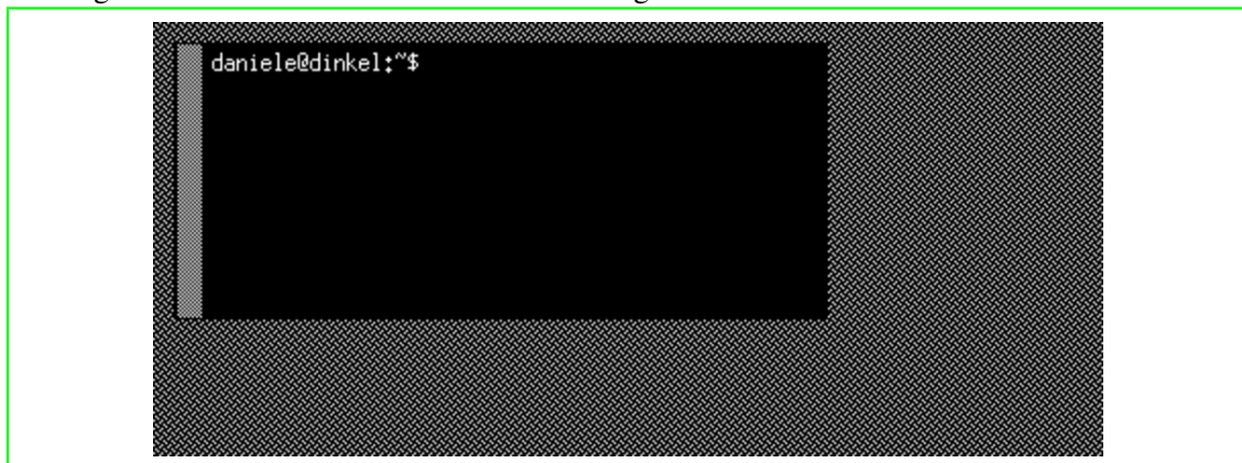
Figura 230.1. Il server X avviato senza un gestore di finestre.
