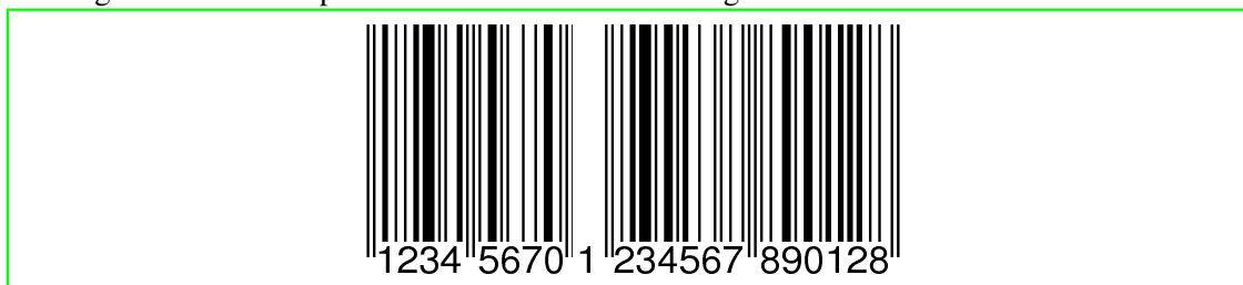
Figura 800.4. Esempi di codici a barre con simbologia EAN-8 e EAN-13.
