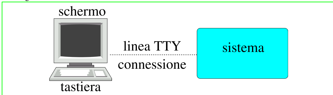
Figura 115.4. Schema banale della connessione di un terminale a caratteri.
