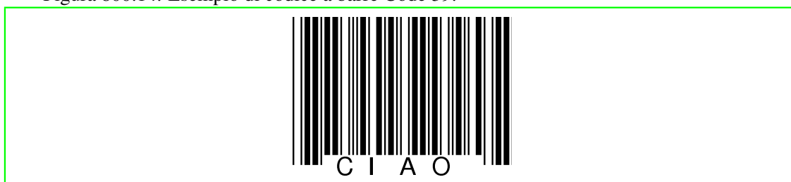
Figura 800.14. Esempio di codice a barre Code 39.
