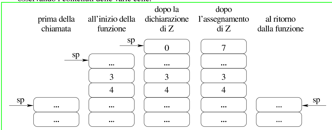
Figura 732.4. Situazione della pila nelle varie fasi della chiamata della funzione 'SOMMA', osservando i contenuti delle varie celle.
