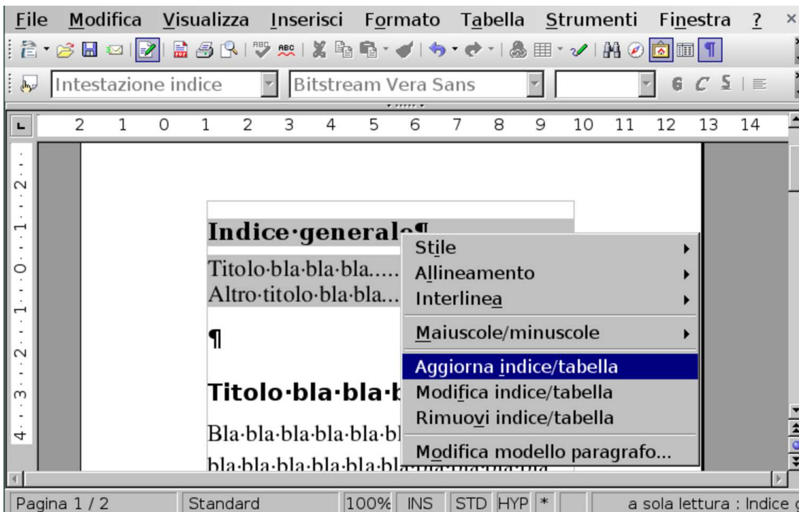
Figura 539.20. OpenOffice Writer: menù contestuale che si ottiene premendo il tasto destro del mouse sulle componenti dell'indice. Va osservata in particolare la voce che richiede l'aggiornamento automatico dell'elenco.
