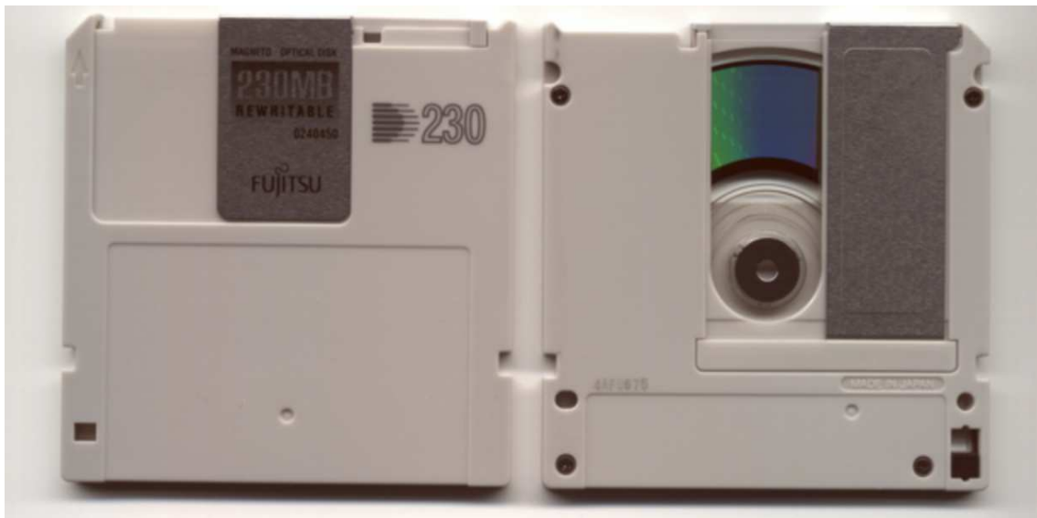
Figura 164.9. Disco magneto-ottico rimovibile.
