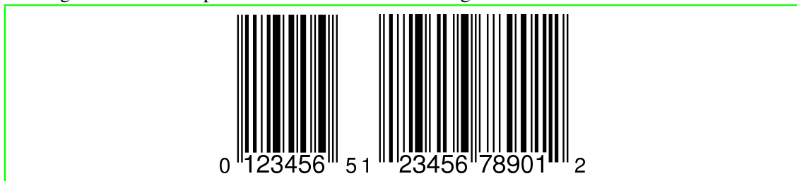
Figura 800.2. Esempi di codici a barre con simbologia UPC-E e UPC-A.
