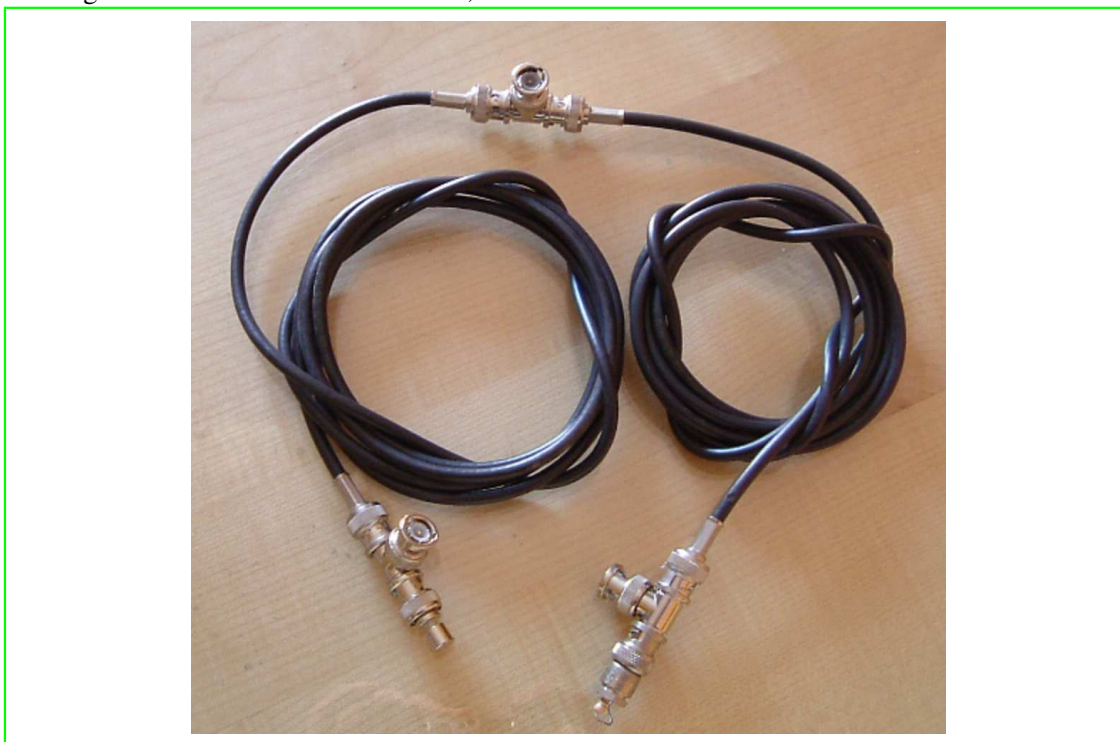
Figura 257.1. Cavo coassiale RG58, connettori a «T» e terminatori resistivi.
