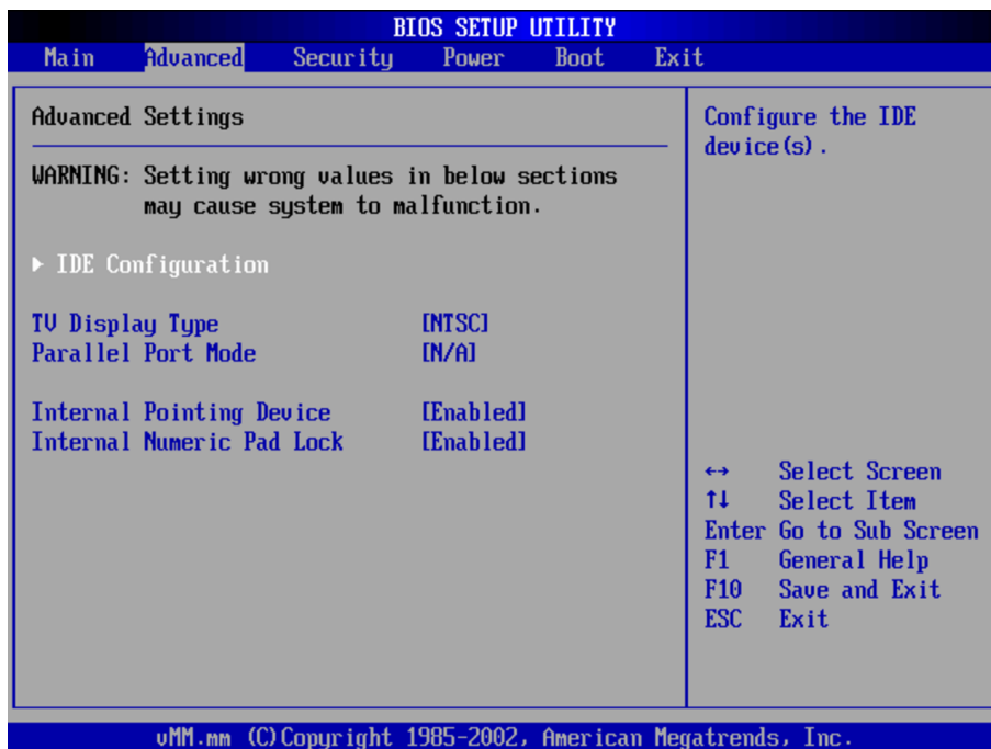
Figura 83.20. Programma di configurazione di un BIOS AMI con menù a tendina: menù avanzato. 1
